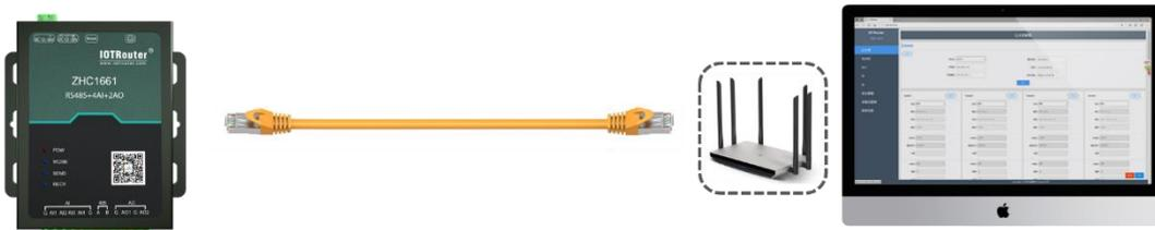
ZHC1661 默认 IP 地址 为 192.168.0.65。配置需要将计算机和 ZHC1661 的 IP 设置成同一个 IP 地址段，否则设备与计算机无法通信。如下图所示：
